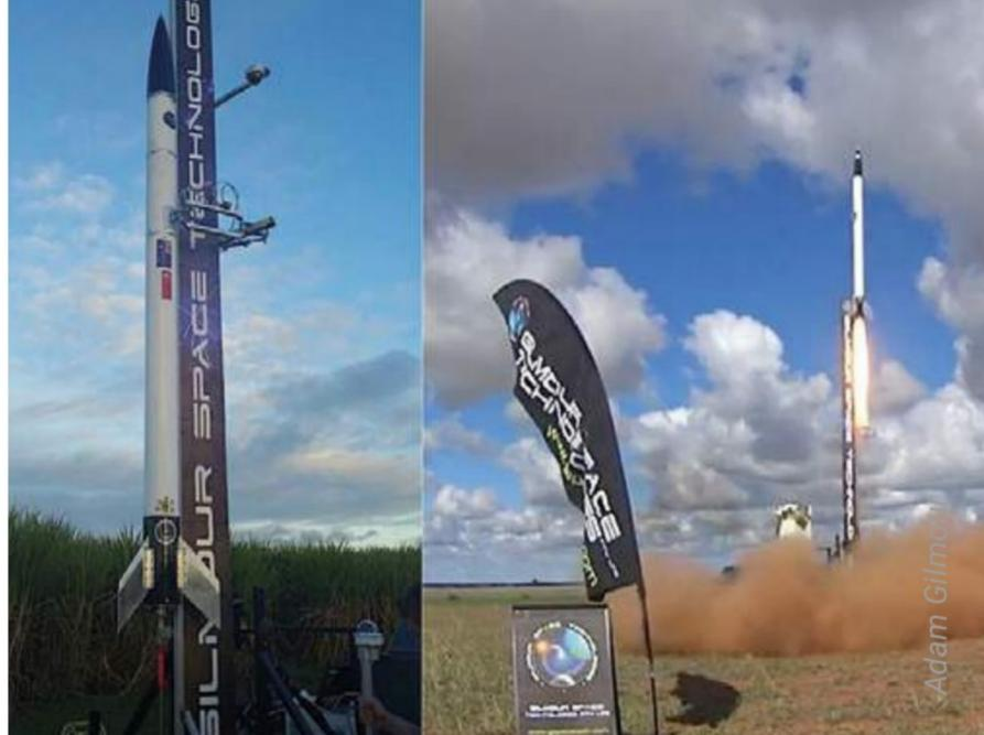
▲ Сход ракеты RASTA с вертикального пускового рельса после включения двигателя во время испытаний 22 июля 2016 г.
