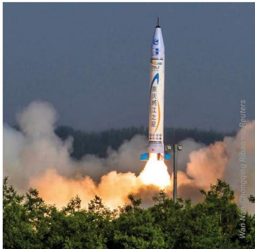
▲ Считается, что эра китайской частной космонавтики началась с запуска компанией OneSpace Technologies одноступенчатой твердотопливной ракеты OS-X, состоявшегося 17 мая 2018 г. Хотя ей и не удалось достичь условной границы космоса (максимальная высота полета ракеты составила 40 км), однако технические характеристики нового носителя вполне позволяют надеяться на большее.
