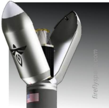
Отсек полезной нагрузки
