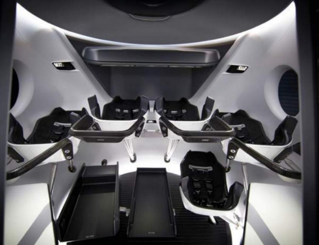
▼ Интерьер капсулы корабля Crew Dragon. Версия, показанная здесь, предназначена для транспортировки на МКС пяти членов экипажа и двух грузовых контейнеров
