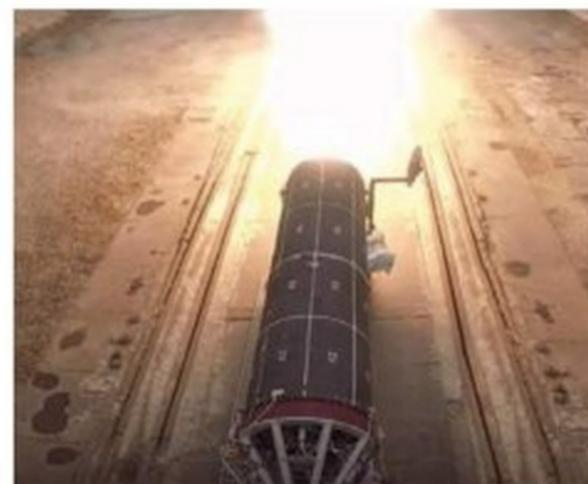
▲ Испытания твердотопливного ракетного двигателя.
