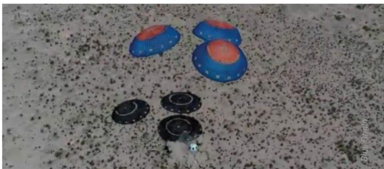
◀ Во время первого испытания системы New Shepard 2 полет герметичной капсулы от момента старта до касания земной поверхности продлился 10 минут 19 секунд. Спуск происходил при помощи трех парашютов; непосредственно перед касанием включились двигатели мягкой посадки, снизив вертикальную скорость до полуметра в секунду. Максимальная достигнутая высота составила 100,5 км
